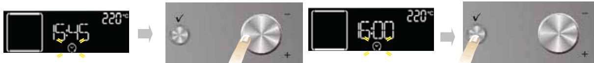
Чтобы сдвинуть время окончания приготовления на более позднее время путем задания отсрочки включения духовки, выполните действия, описанные ниже.
