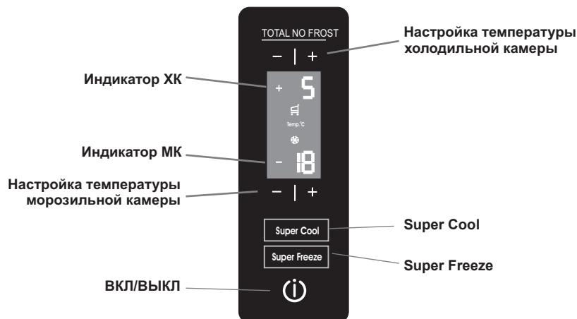
**ВКЛ/ВЫКЛ** - нажатием данной кнопки можно включить весь прибор в целом (как холодильную, так и морозильную камеры). Для отключения холодильника достаточно нажать и удерживать в течение 3 секунд кнопку, холодильник выключится с задержкой 6 секунд.
