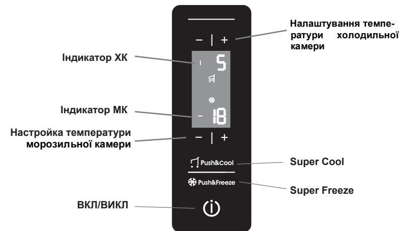
**ВКЛ/ВИКЛ** - натисканням цієї кнопки можна включити весь прилад в цілому (як холодильну, так і морозильну камери).
