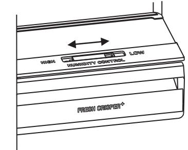
Овощной ящик с функцией регулирования влажности **Humidity**. Регулирование осуществляется перемещением заслонки: влево - для небольшого количества продуктов и повышения влажности; вправо - для большего количества продуктов и снижения влажности.
