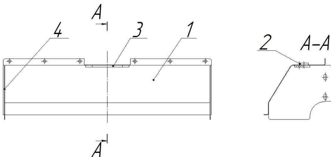
Рисунок 2 – Ограждение ФР-00.050-Б
