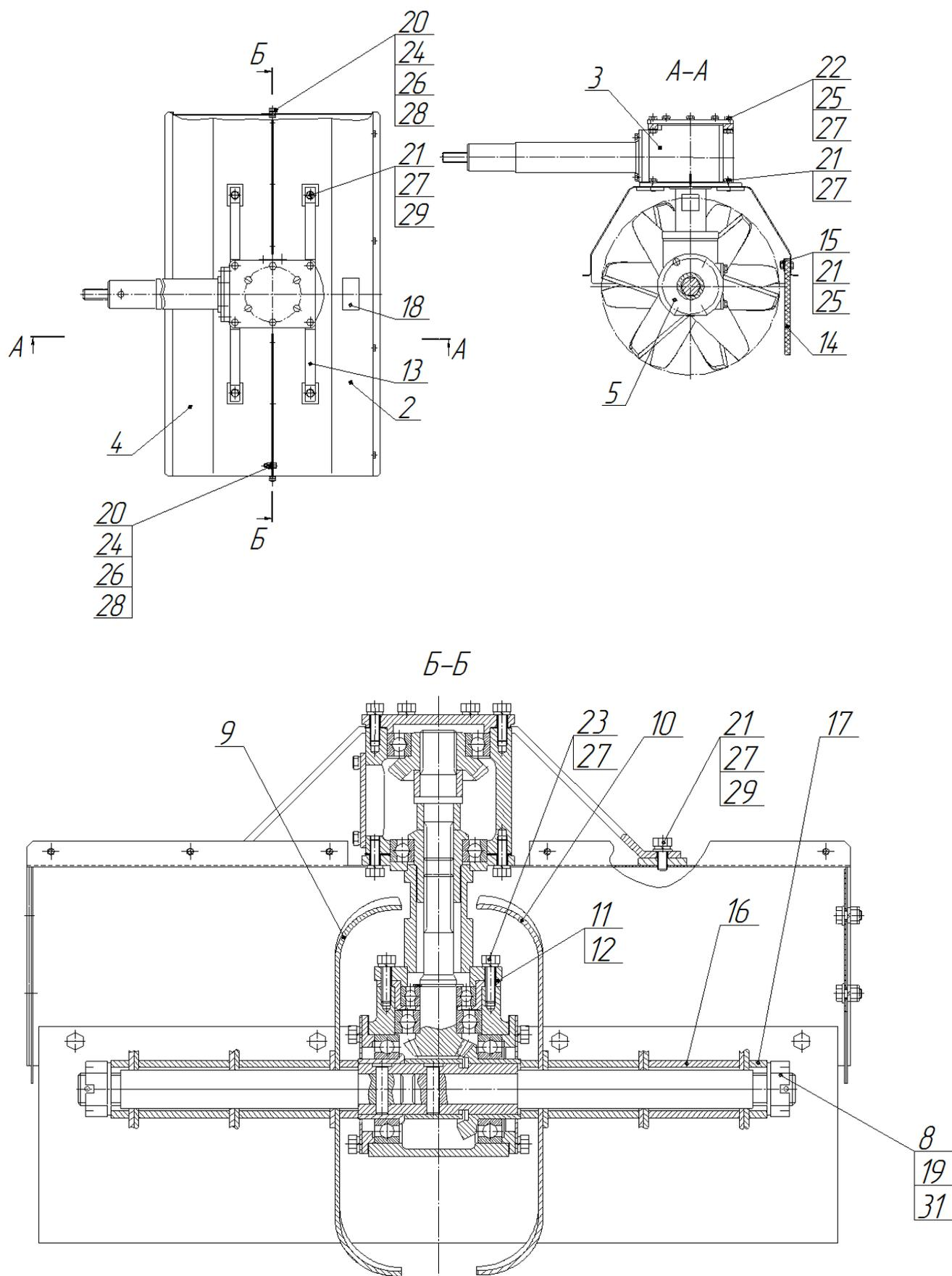
Рисунок 1 – Фреза почвенная
