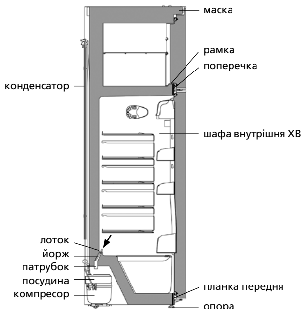
Рисунок 4 – Схема зливу талої води із ХВ
