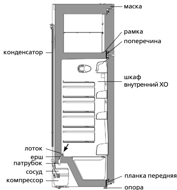
Рисунок 4 – Схема слива талой воды из ХО
