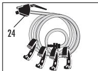
Экстракционная трубка с запорным вентилем (24) и кольцами для монтажа на шланг
