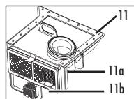
Комплект АКВА-фильтра (11) с губчатым фильтром (11a) и всасывающим фильтром (11b)\*
