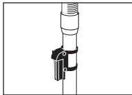
Изменяющаяся по высоте телескопическая всасывающая труба с фиксатором для стоячного положения
