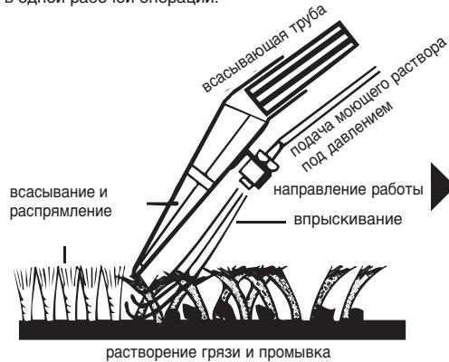
Нажать рычаг запорного клапана (24) до выхода моющей жидкости, а приложенную к ковру насадку провести прямой полосой по ковру. В конце полосы или при перерыве отпустить рычаг клапана, чтобы остановить струйное распыление. После того как распыленная жидкость собрана, приподнять насадку и начать новую полосу с небольшим наложением на предыдущую. Так полосы за полосой можно обработать всю поверхность.
