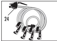
Розпилювальна труба з запірним клапаном (24) за встановленими затискачами
