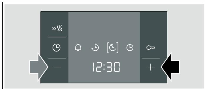
Через несколько секунд установка будет принята, духовой шкаф перейдёт в режим ожидания. На дисплей выводится время, к которому блюдо должно быть готово, символ  $\odot$  заключается в скобки. Символы  $\ominus$  и  $\odot$  гаснут. Когда духовой шкаф включится, символ  $\odot$  будет взят в скобки, и начнётся обратный отсчёт времени выполнения. Символ  $\odot$  гаснет.
