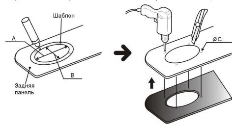
Если под декоративной панелью проходит металлический корпус автомобиля, тогда для установки акустической системы Вам необходимо действовать следующим образом:
