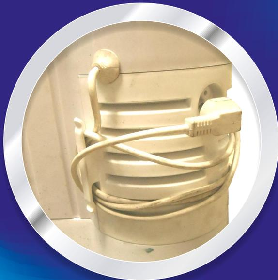
Для того, чтобы электрический шнур от стиральной машины не мешал, когда машина не используется на задней стенке выделено место для намотки шнура и фиксации вилки.
