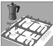
Предназначена исключительно для использования на вспомогательной конфорке с посудой диаметром менее 12 см.
