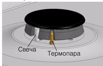
В зависимости от модели, варочная панель может быть оборудована системой газ-контроль (термопарой), которая препятствует утечке газа при случайном угасании пламени на горелках. Для того, чтобы обеспечить включение этой системы, зажгите конфорку как обычно и удержите рукоятку в нажатом состоянии в течение 4 секунд после того, как зажжется пламя.
