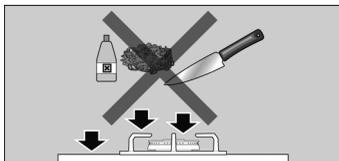
Если на варочной панели имеется стеклянная или алюминиевая поверхность, не пользуйтесь для очистки ее стыков с металлом ножами, скребками и другими подобными инструментами
