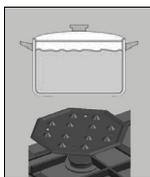
Данное приспособление предназначено для снижения температуры нагрева в режиме минимального нагрева. Установите приспособление прямо на решетку рельефной стороной вверх. Никогда не ставьте его прямо на горелку конфорки. Поставьте посуду по центру приспособления. Артикул HEZ298105.
