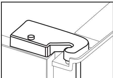
**i** Установите на место крышку петли и зафиксируйте винтом.
