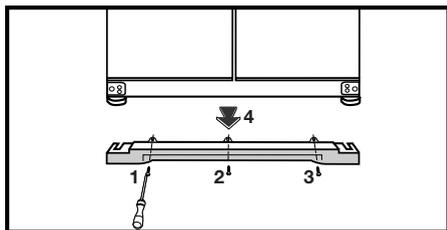
1- Отвинтите винты, которые держат вентиляционную крышку, как показано на рисунке. Вы можете отрегулировать устойчивое положение холодильника вращением передних ножек, как показано на рисунке. Угол холодильника, под которым находится ножка, будет опускаться, если поворачивать ее в направлении черной стрелки, или подниматься, если поворачивать ее в противоположном направлении. Если слегка приподнять холодильник, это облегчит процесс.
