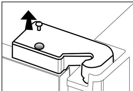
❶ Используя отвертку, выньте винт из крышки верхней петли той двери, которую нужно отрегулировать.
