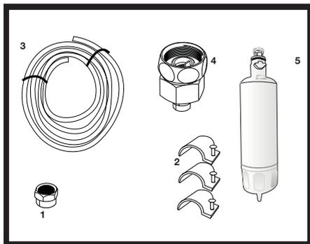
Сначала определите место крепления внешнего фильтра. (Относится к фильтру, используемому вне холодильника.) Затем измерьте расстояние между фильтром и холодильником и необходимую длину шланга от фильтра до отверстия подачи воды.
