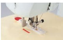
Механизм выметывания петель в один прием с автоустановкой размера позволяет создавать абсолютно одинаковые петли. Просто выберите функцию выметывания петель и следите за направлением шитья всех 4-х сторон петли без поворота рычага.
