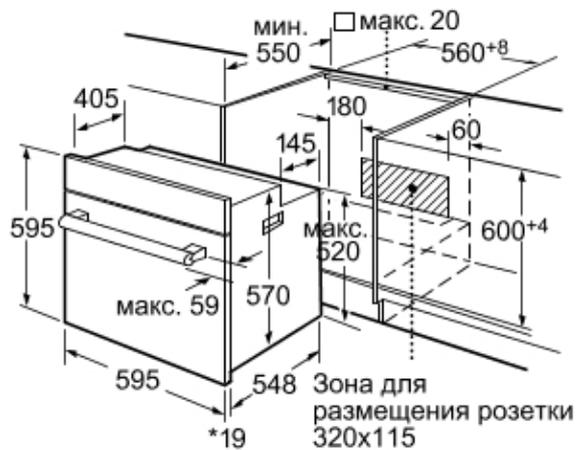
\*При металлической фронтальной панели 20 мм
