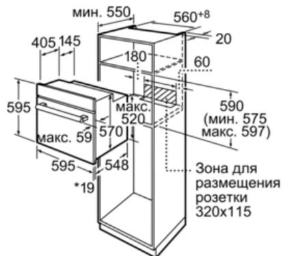
\*При металлической фронтальной панели 20 мм
