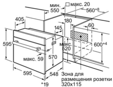
\*При металлической фронтальной панели 20 мм
