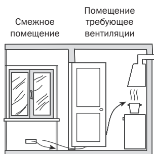
Рис. 3. Обеспечение необходимого зазора между дверью помещения и порогом для свободного прохода приточного воздуха
