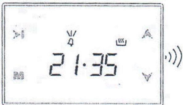
По истечении запрограммированного времени таймера прозвучит звуковой сигнал. Нажатием любой сенсорной кнопки его можно отключить.
