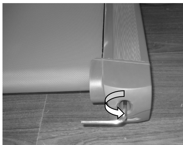
Поверните винт против часовой стрелки, чтобы уменьшить натяжение бегового полотна
