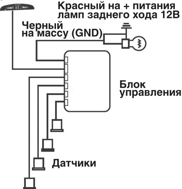
Общая схема подключения парковочных радаров PS-126U/PS-128U/PS-528
