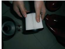
6. Промойте фильтр под струей воды (без добавления каких-либо моющих средств), ПОЛНОСТЬЮ высушите его и затем установите его на крышке пылесборника в обратной последовательности.
