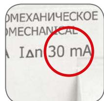
**Номинальный отключающий дифференциальный ток  $I_{\Delta n}$**  – это значение отключающего дифференциального тока, при котором УЗО должно срабатывать при заданных условиях.
