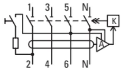
При установке устройства необходимо убедиться в том, что в зоне защиты ВДТ нулевой рабочий проводник N не имеет соединений с заземленными элементами и нулевым защитным проводником PE.
