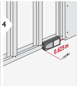
Медленно перемещайте прибор вдоль линии разметки. На дисплее отобразится расстояние до следующей точки разметки.
