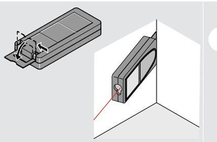
**i** Положение позиционной скобы определяется автоматически и соответственно устанавливается точка отсчета.
