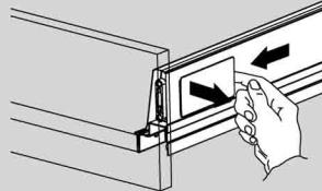
5 Для снятия фасада поверните крестовую отвёртку по стрелке и снимите фасад. Предварительно отсоедините рейлинги если они установлены.
