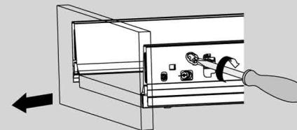
6 Для снятия всего ящика - поднимите вверх рычажок и освободите ящик от фиксации с направляющими.
