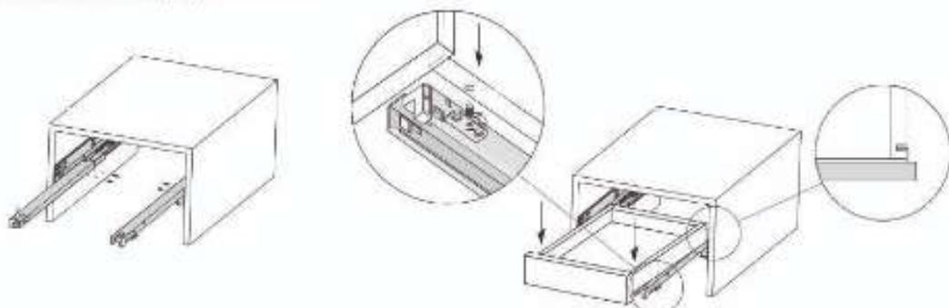
3. 3.1 Задрите фиксаторы подняв ящик
