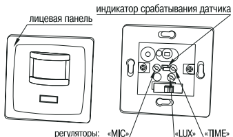
Рисунок 15 – Конструкция датчика движения ДД-035
