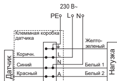
Рисунок 18 – Схема подключения датчиков ДД-017, ДД-019
