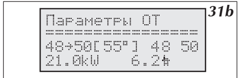
Рис.31b Просмотр параметров отопительной системы (ЕКСО.ТМ)
