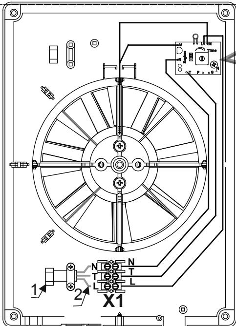
Рис.1.Схема монтажная вентилятора STANDARD-ET.
