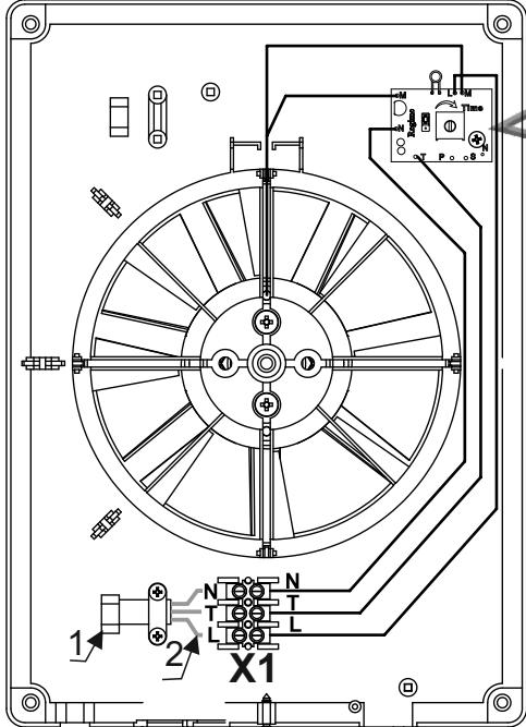
Рис.1.Схема монтажная вентилятора STANDARD-ET.
