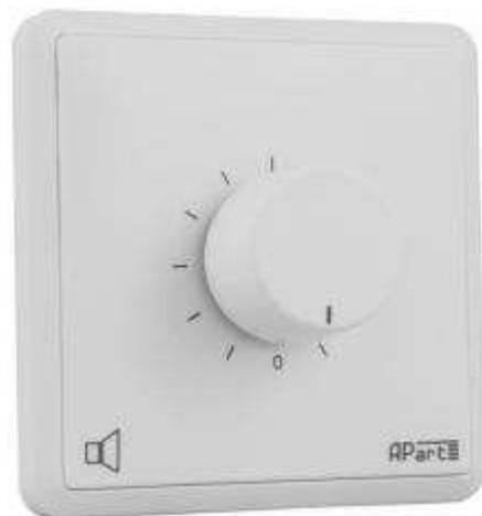
APart E-VOL120 имеет реле обхода с управляемым напряжением 24 В. Эта функция позволяет подать аварийный сигнал даже в том случае, если регулятор громкости установлен в положение "0".
