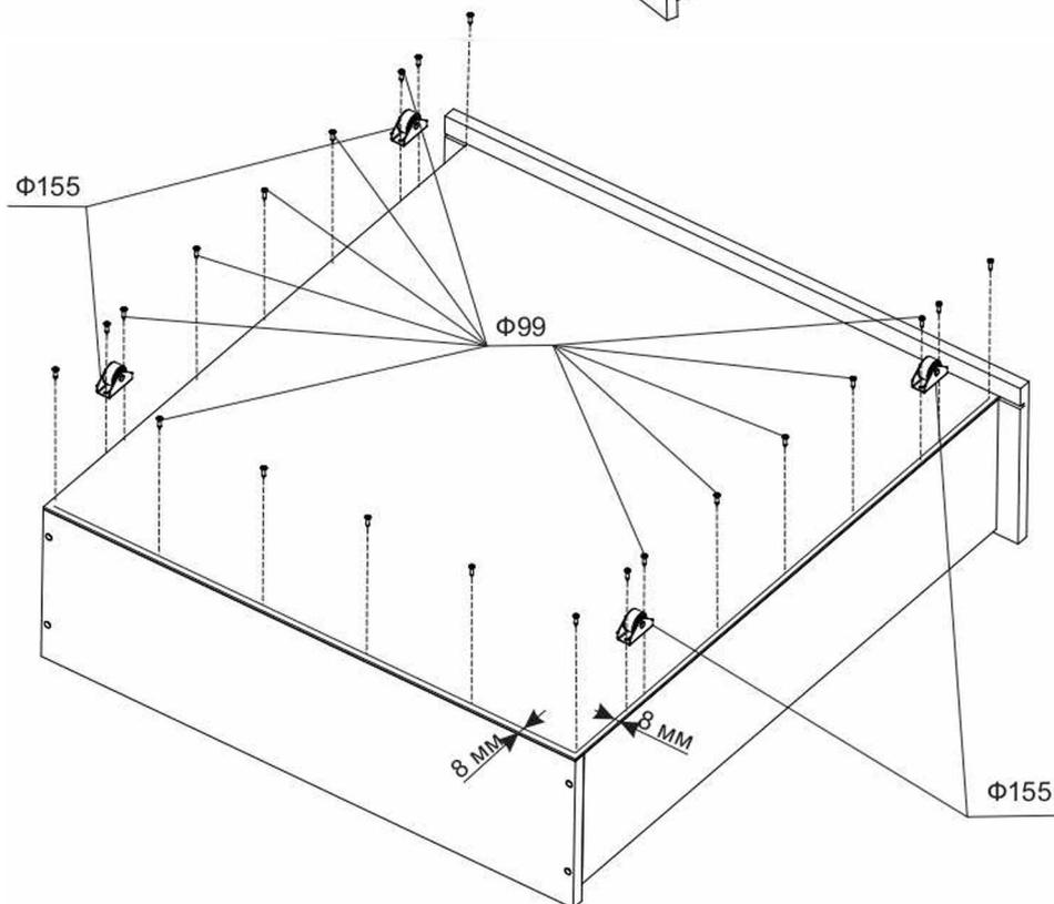
Во избежании сколов на стенках боковых ящика Я4 и стенке задней ящика Я2, саморезы  $\Phi 99$  вкручивать, отступив от края примерно 8 мм.
