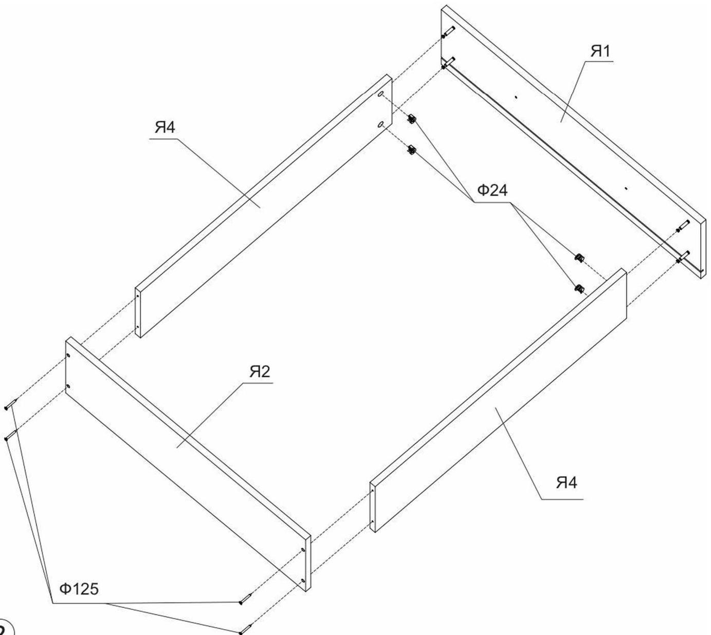
Перед установкой дна ящика, следует, при помощи шнура или рулетки проверить диагонали полученного каркаса. Диагонали должны совпадать ( $L1=L2$ )
