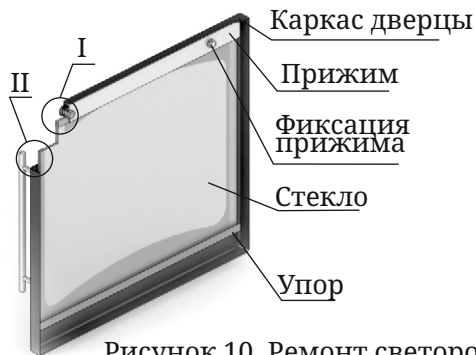
Рисунок 10. Ремонт светопрозрачного экрана дверцы модификации «Витра»
