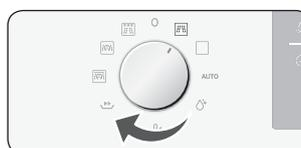
2. Поверните **МНОГОФУНКЦИОНАЛЬНЫЙ ПЕРЕКЛЮЧАТЕЛЬ**, чтобы установить необходимое время приготовления. Если уровень мощности менять не требуется, нажмите **ПУСК**, чтобы начать приготовление.
