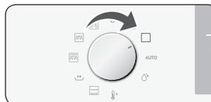
2. Поверните регулятор **МНОГОФУНКЦИОНАЛЬНЫЙ ПЕРЕКЛЮЧАТЕЛЬ** в положение необходимого режима печи. Будут отображены режим печи и рекомендуемая температура.
