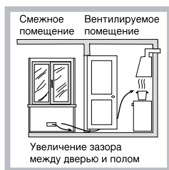
В Увеличение зазора между дверью и полом
