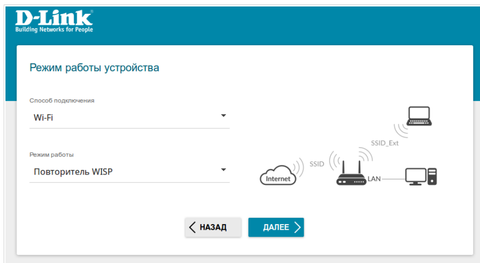
Рисунок 25. Выбор режима работы устройства. Режим Повторитель WISP .
