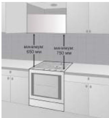
Рис.6 Минимальные расстояния от газовой, электрической плиты
