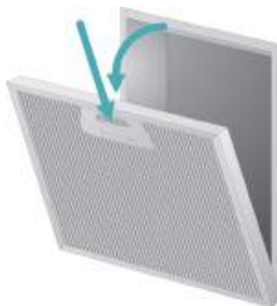
Рис. 12 Снятие алюминиевого жировоулавливающего фильтра
