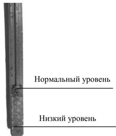
Рисунок 5 – Проверка уровня масла в корпусе редуктора
