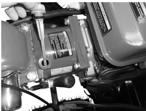
Рисунок 5 – Проверка уровня масла в корпусе редуктора
