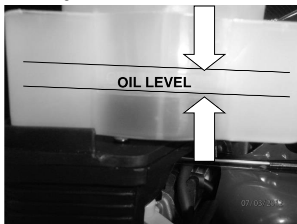
Рисунок 7 – Уровень масла в корпусе воздушного фильтра
