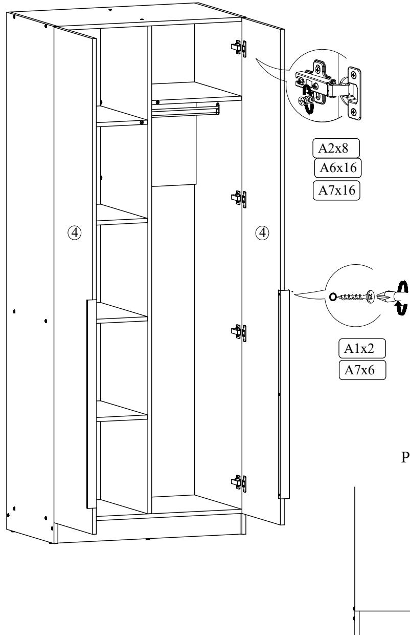
Двери фиксируются на стойку шкафа при помощи шурупов А6, после чего производится регулировка дверей.
