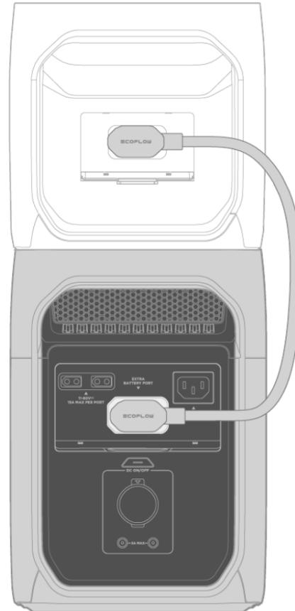
1. Подключите дополнительный аккумулятор к соответствующему разъему на электростанции.
