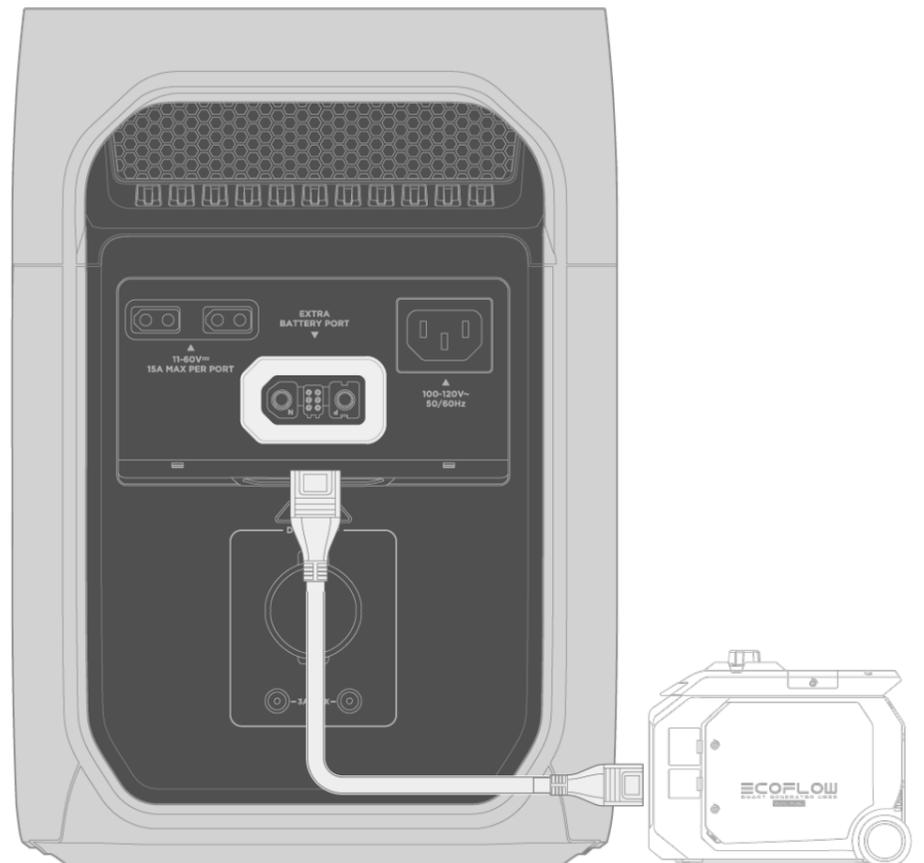
**i** Данный метод подключения доступен только через Умные генераторы EcoFlow.
