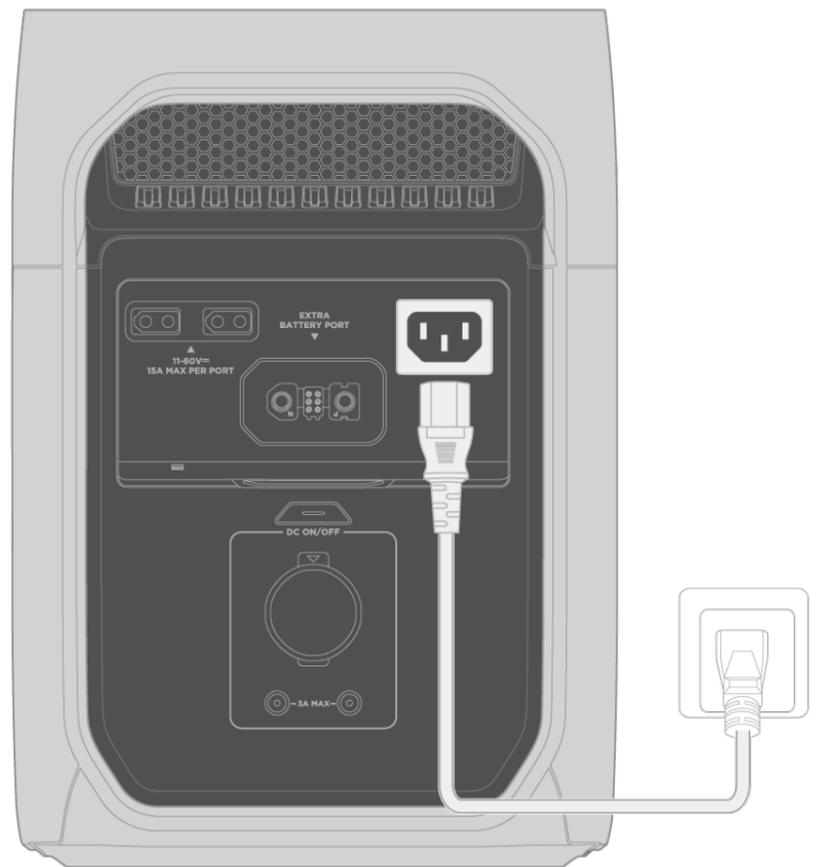
Подключите входной порт переменного тока электростанции к розетке с помощью прилагаемого **зарядного кабеля переменного тока**.
