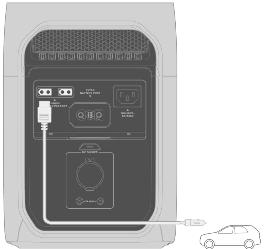
**i** Чтобы избежать проблем с запуском двигателя из-за низкого уровня заряда аккумулятора автомобиля, подключайте зарядный кабель только после того, как двигатель будет запущен. Кроме того, убедитесь, что кабель надежно подключен к прикуривателю.
