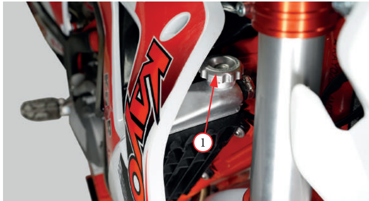
Фото 5.6. Контроль уровня охлаждающей жидкости
