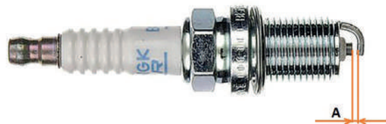
Фото 5.16. Зазор между электродами свечи зажигания
