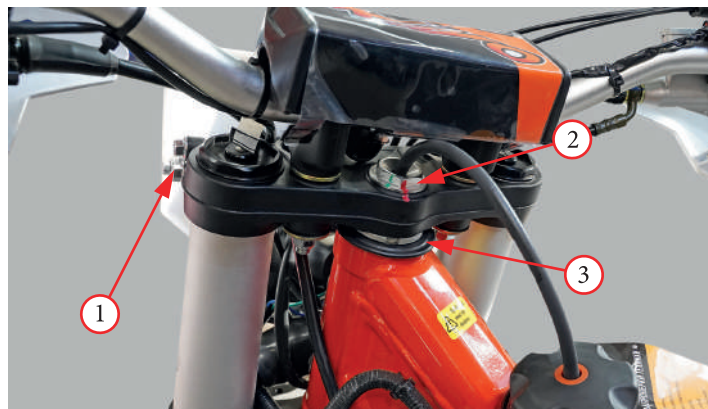
Фото 5.33. Регулировка подшипников рулевой колонки
