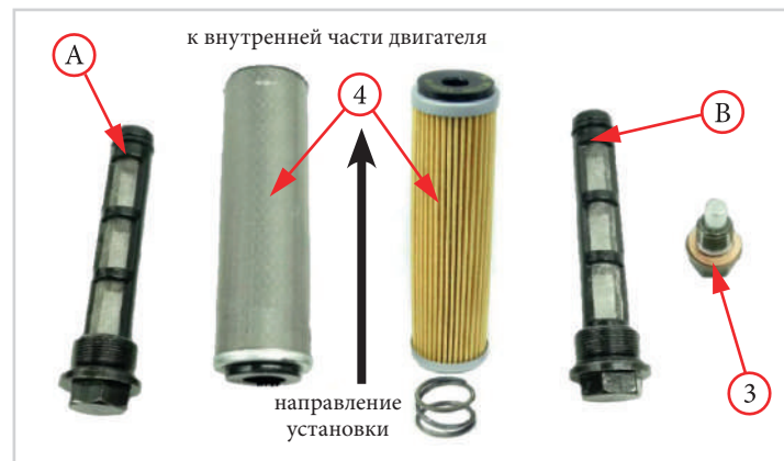
Фото 5.4.1. Замена масла в двигателях с масляным фильтром
