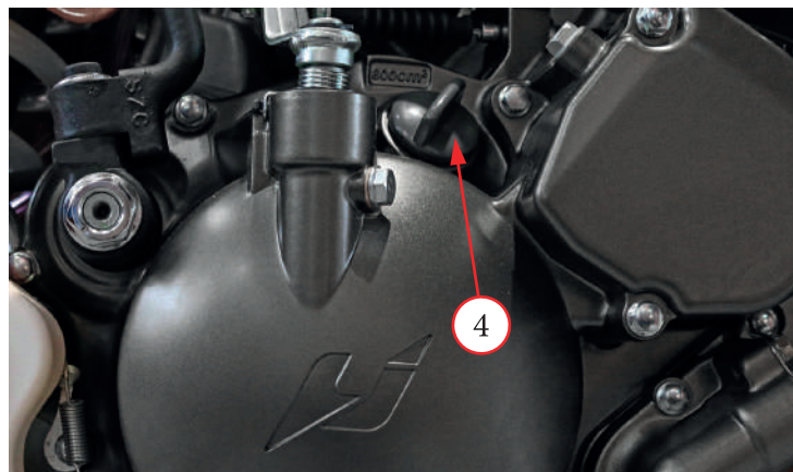
Фото 5.1.1. Исполнение смотрового окна и крышки горловины двигателей
