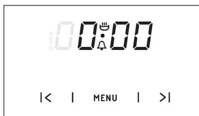
● установить нужное время работы минутного таймера при помощи сенсор > и <.
