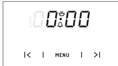
• Zeitdauer am Timer mit den Sensoren > und < einstellen. Die eingestellte Zeitdauer ist an der Anzeige zu sehen und die Betriebsfunktion
