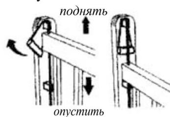
**Внимание!** На одной из продольных планок детали 3Д имеются отверстия под направляющие механизма опускания планки 5К. Они должны быть направлены вверх (как показано на выноске С).
