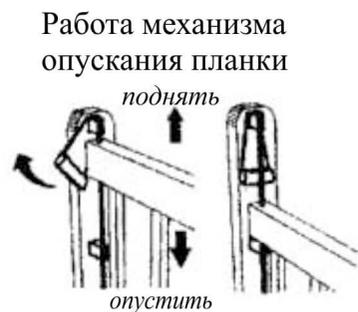
**Внимание!** На одной из продольных планок детали 3Д имеются отверстия под направляющие механизма опускания планки 5К. Они должны быть направлены вверх (как показано на выноске С).
