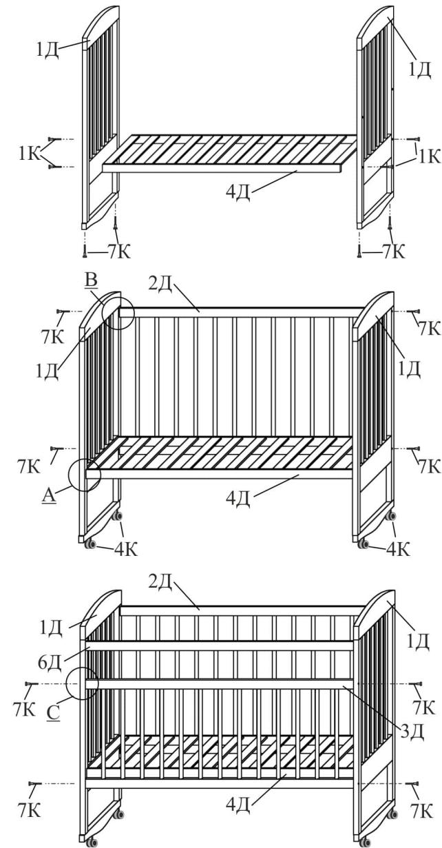
Внимание! На одной из продольных планок детали 3Д имеются отверстия под направляющие механизма опускания планки 3К. Они должны быть направлены вверх (как показано на выноске С).
