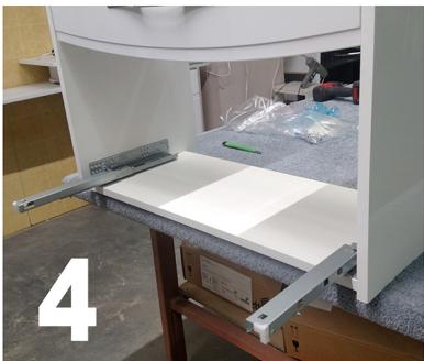
5. Установите ящики на направляющие и задвиньте до трёх характерных щелчков. Обратите внимание на корректное защёлкивание заднего язычка направляющей.
