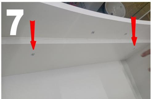
8. Проверьте правильность установки демпферов на верхнем и нижнем фасаде.
