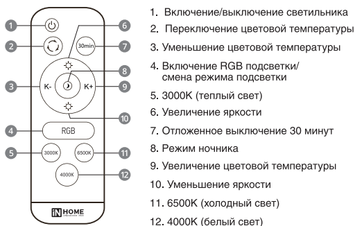
Рис. 1 Управление светильником с RGB
