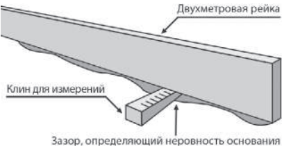
Рис. 1. Измерение неровности основания
